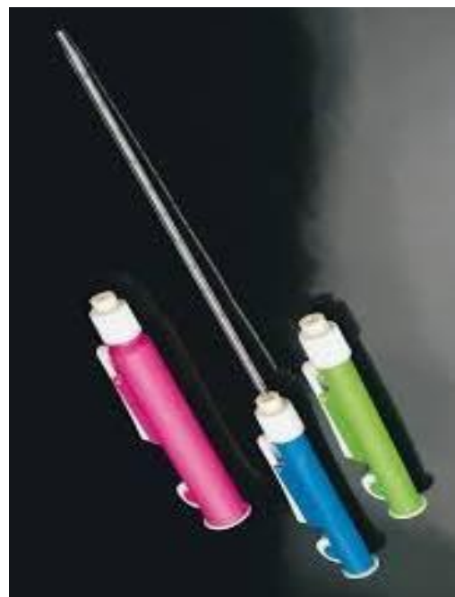
სურათი 4. 84. პიპეტებში ნივთიერების ამოსატუმბი მოწყობილობა
