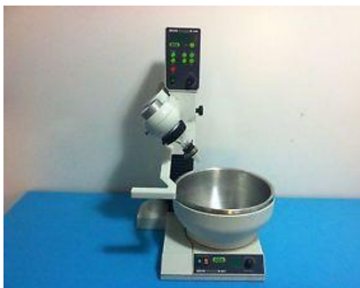
სურათი 4. 108. სხვადასხვა კონსტრუქციის როტაციული ამორთქლებლები
