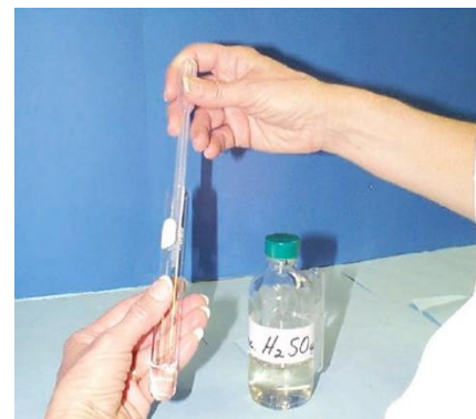
სურათი 4. 69. გოგირდმჟავას სიმკვრივის დადგენა
