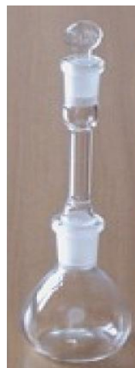
სურათი 4. 56. პიკნომეტრით სიმკვრივის განსაზღვრა
