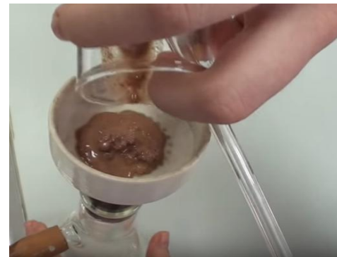
სურათი 4. 96. გასაფილტრი ნარევის გადატანა ფილტრზე.
