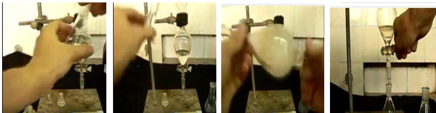
სურათი 4. 119. ექსტრაქციის პროცესის თანმიმდევრობა: 1. საკვლევი სითხის ჩასხმა; 2. ექსტრაგენტის დამატება; 3. ანჯღრევა; 4. ექსტრაქტის ჩამოსხმა.
