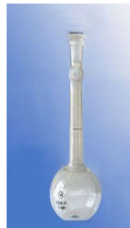
სურათი 4. 56. პიკნომეტრით სიმკვრივის განსაზღვრა
