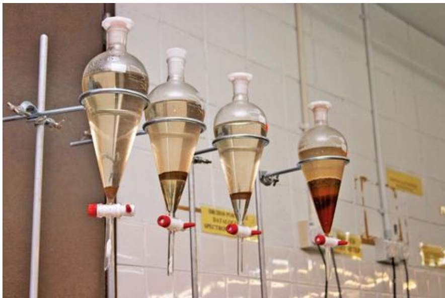
სურათი 4. 117. მსხლისებრი გამყოფი ძაბრები საექსტრაქციო ხსნარით
