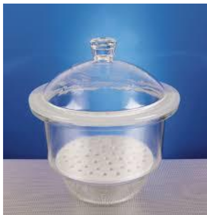
სურათი 4. 68. ექსიკატორები: ა) უონკანო; ბ) ონკანიანი
