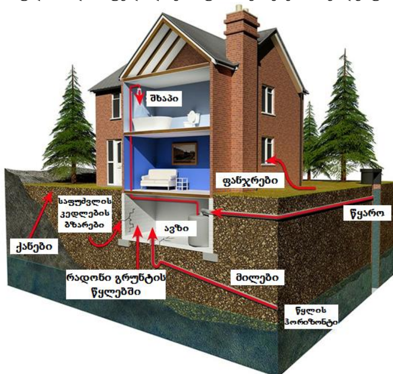
სურათი 2.20. რადონის შეღწევა შენობებში
