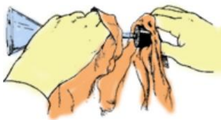
სურათი 4.20. მინის დეტალებზე რეზინის მილების ჩამოცმა
