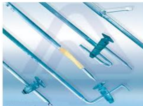
სურათი 4. 79. ონკანიანი და უონკანო ბიურეტები
