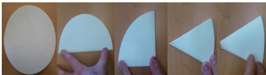
სურათი 4. 93. ნაკეცებიანი ფილტრის ქაღალდის მომზადება
