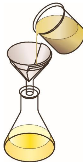
სურათი 4. 111. ნარევის ცხლად გაფილტვრა
