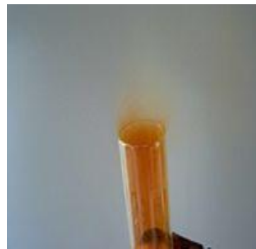
სურათი 4. 49. 1, 2 - მეტალების წვა, 3 - მეტალების წვით \text{NO}_2 -ის გამოყოფა
