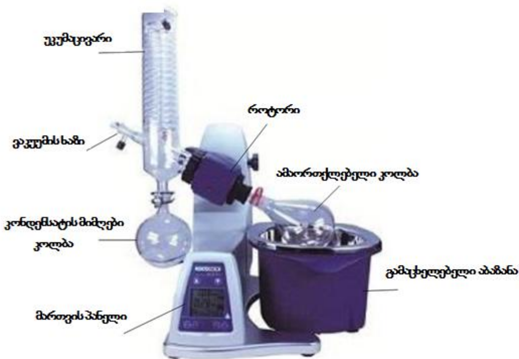
სურათი 4. 109. UL-1100 ტიპის როტაციული ამორთქლებელი
